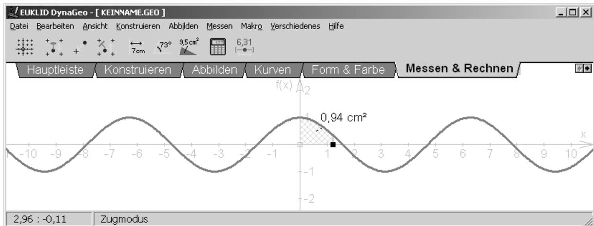
Nun konstruiert man – analog zu oben – den Funktionsgraphen jener Funktion, die jedem Punkt (eigentlich der x-Koordinate jedes Punktes) die Fläche unter dem Graphen bis zu jenem Punkt (hier: ausgehend vom Nullpunkt) zuordnet. Man erhält:
