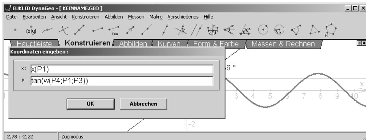
Bewegt man jetzt den Punkt P1 entlang des Graphen und zeichnet seine Ortstlinie auf, so erhält man den Graphen der Ableitungsfunktion als Steigungsfunktion der Tangente:
