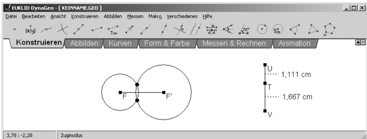
Durch Veränderung der Position von  $T$  erhält man mehrere Ellipsenpunkte. Diese kann man auch mit dem Befehl „Ortslinie eines Punktes aufzeichnen“ als Spur zeichnen lassen und erhält so eine (fast) vollständige Ellipse:
